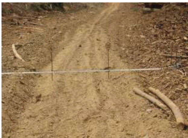
Figure 3. Field measurement points on cross section. Puntos de las mediciones en la sección transversal de la vía.
